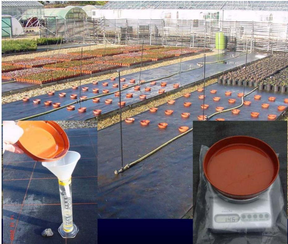
Obr. 3 Testování vydatnosti a rovnoměrnosti postřikovačů ve skleníku
