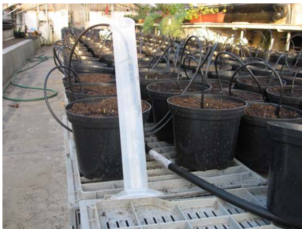
Obr. 4 Měření vydatnosti kapkovacích jehel pomocí odměrného válce
