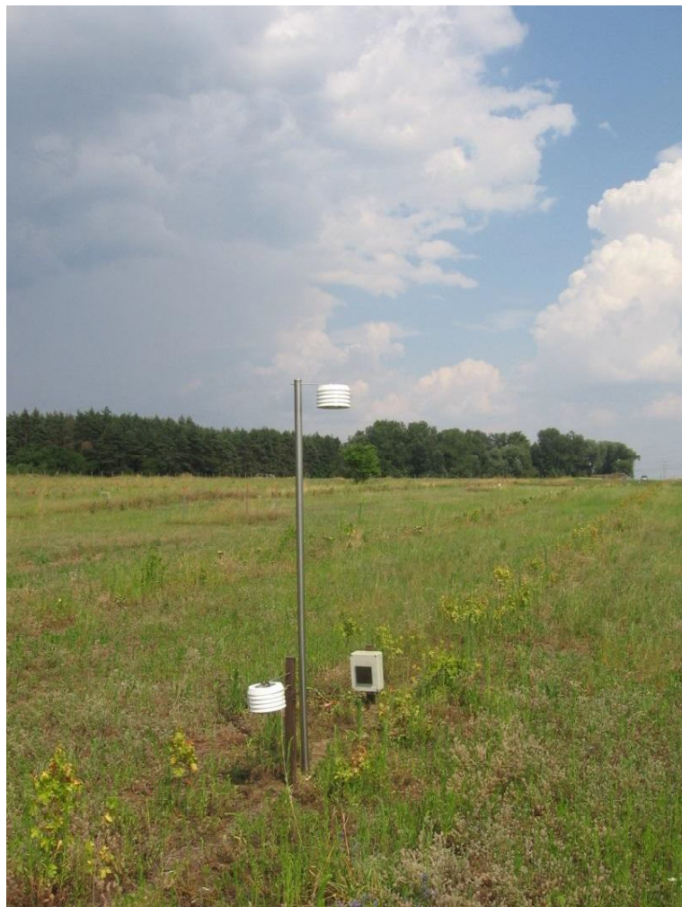
Obr. 3 Pohled na měřicí stanoviště, v plastových stínítkách jsou umístěny datalogery na měření teploty a vlhkosti, ve skříňce se solárním panelem je datalogger registrující půdní teploty a vlhkosti. Stav z července 2010
