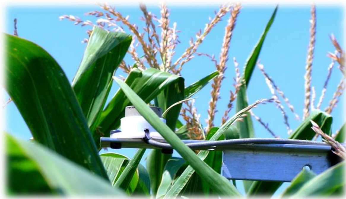
Obr. 14 Zařízení na měření sluneční radiace v porostu
