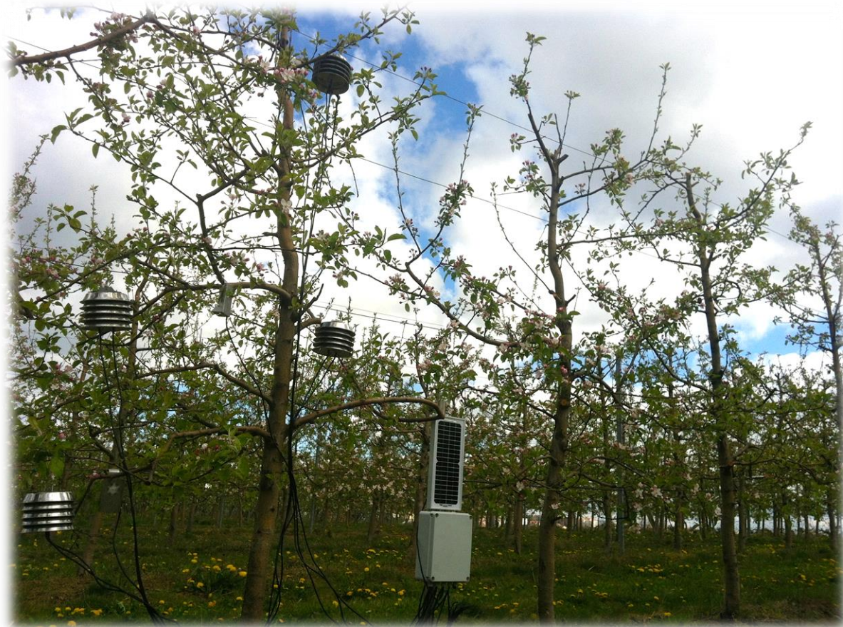
Obr. 8 Ukázka umístění automatických teploměrů v ovocném sadu – teplota vzduchu i vlhkost
