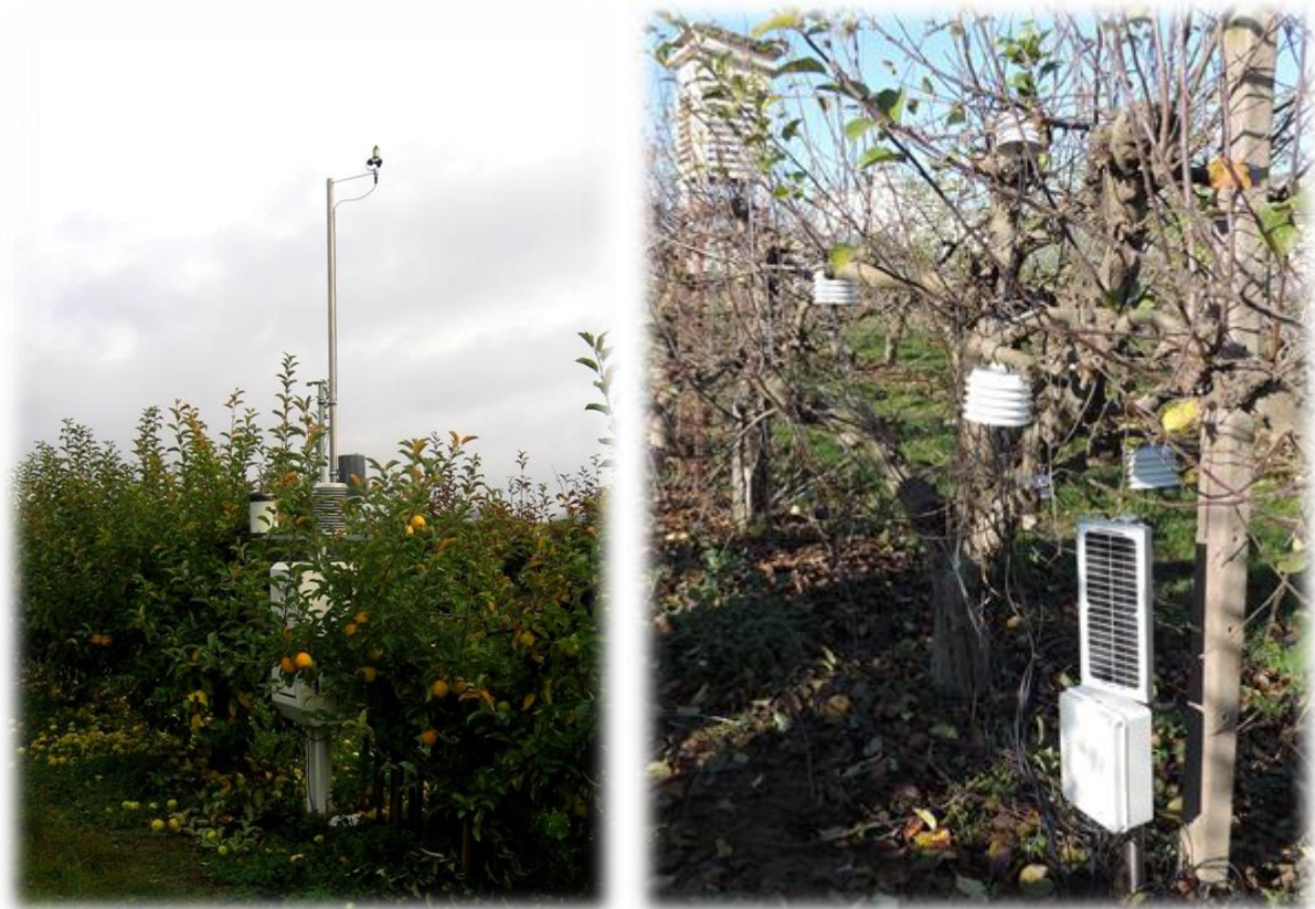
Obr. 2 Automatická meteorologická stanice umístěná v sadu pro účely signalizace chorob a škůdců
