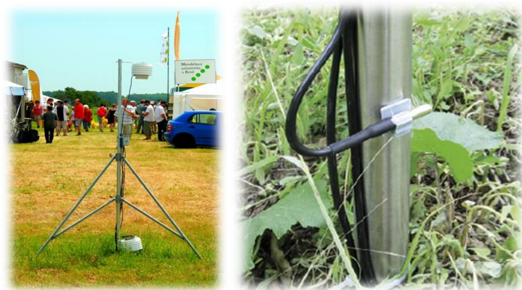
Obr. 11 Kombinovaná stanice pro měření přízemní teploty (čidlo i s krytem) a teploty vzduchu (vlevo); čidlo pro měření přízemní teploty umístěné na meteorologické stanici (vpravo).
