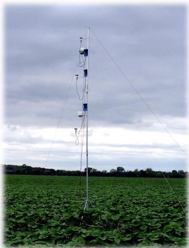
Obr. 13 Umístění anemometrů v porostu při experimentálním měření
