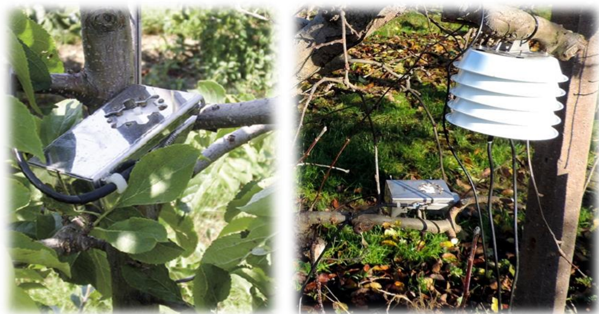
Obr. 7 Zařízení na měření ovlhčení listu (vlevo) a jeho umístění společně se snímači teploty a vlhkosti vzduchu v sadu (vpravo)
