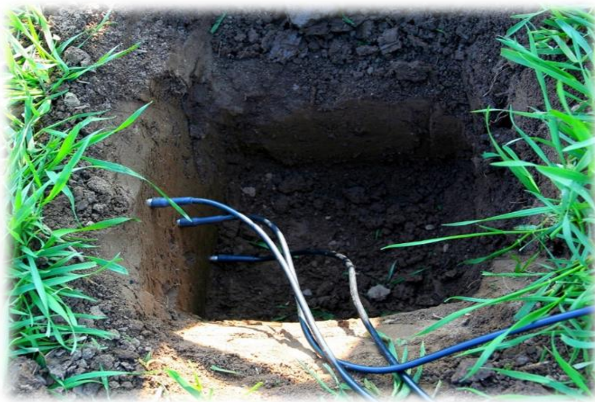
Obr. 12 Elektrické půdní teploměry a jejich umístění v půdním profilu
