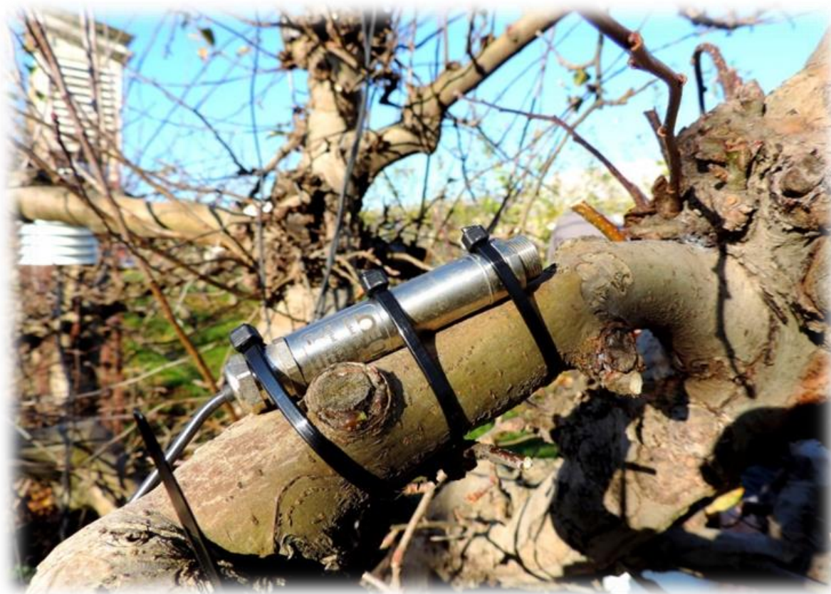
Obr. 10 Infračervený teploměr pro měření teploty kůry ovocného stromu v sadu sloužící k dlouhodobému měření teploty povrchu kůry
