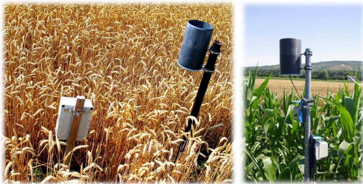
Obr. 3 Ukázka umístění srážkoměru v porostu polní plodiny (pšenice a kukuřice)
