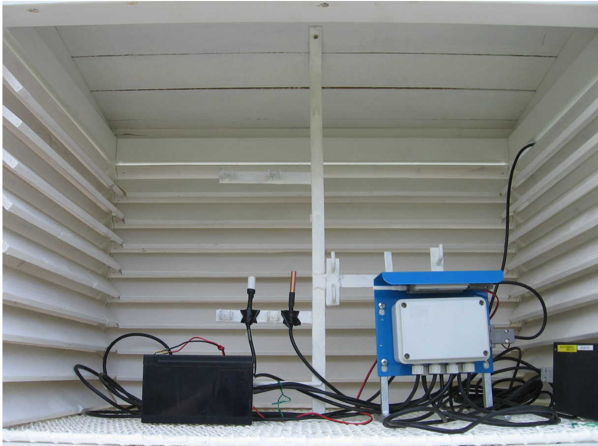
Meteorologická budka vybavená automatickou stanicí, vlevo jsou snímače teploty a vlhkosti vzduchu, v krabičce pak vlastní elektronická část včetně modemu na přenos dat pomocí GSM. Další snímače jsou umístěny vně budky.
