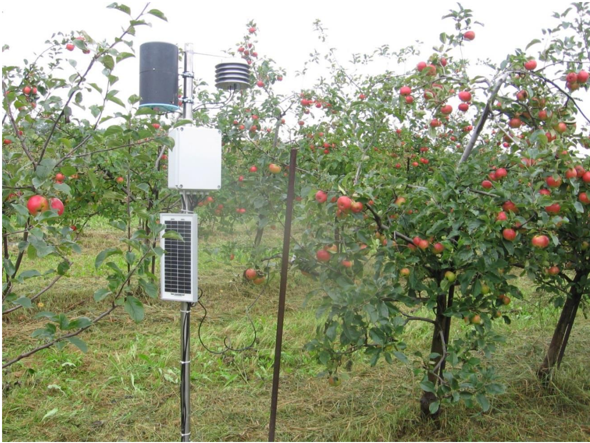
Ukázka meteorologické stanice umístěné přímo v jabloňovém sadu
