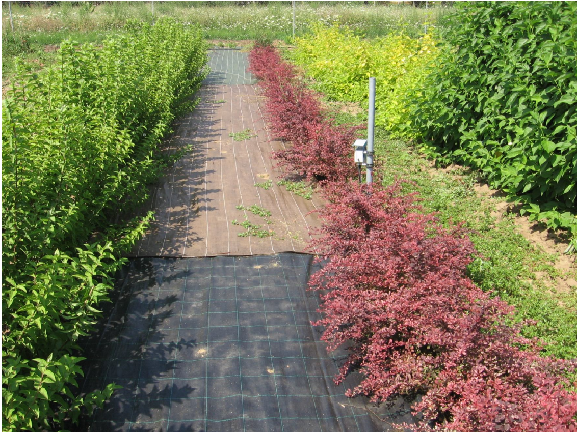
Obr. 1 Uspořádání experimentu s tkanými textiliemi, vpravo datalogger půdních teplot
