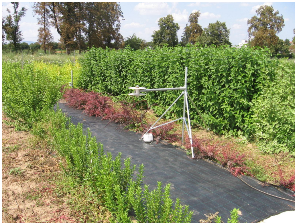
Obr. 3 Měření albeda jednotlivých povrchů dne 7.8.2009
