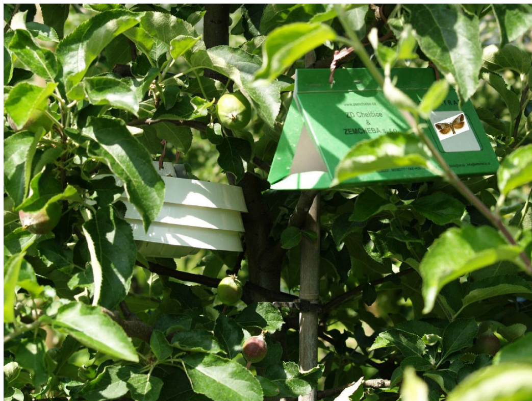
Obr. 1 Feromonový lapák a čidlo pro měření teploty a vlhkosti vzduchu umístěné v porostu jabloní
